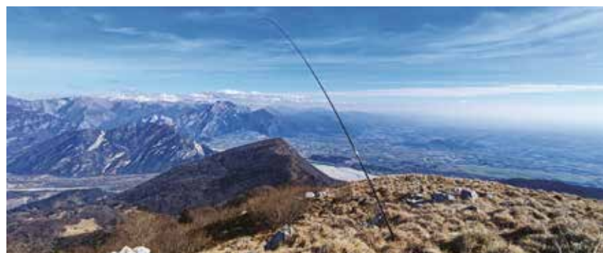
Antenna end fed multibanda installata a V invertita (foto di Maurizio Dose, IV3GVY). Il progetto per costruirla si trova nella rubrica «Per un pugno di watt» di RR 10/2023
