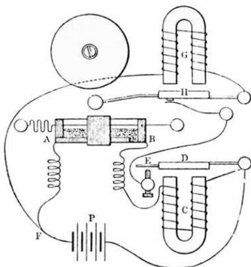
*Il coherer a decoesore di Popov, parte di ricevitore brevettato nel luglio 1899. Si tratta dell'unico brevetto richiesto dal fisico russo in materia di radiotelegrafia.*
