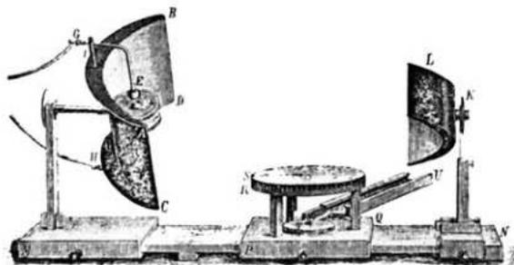
Banco di Righi per esperienze con onde di 10,6 cm, costituito da un oscillatore e da un risuonatore con riflettori a parabola di cilindro.
