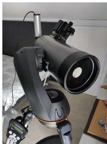
Fig. 8 • Telescopio con sensore ottico inserito al posto dell'oculare e TX Laser accoppiato
