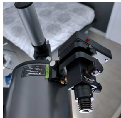
Fig. 9 • Dettaglio della testina laser con regolazioni micrometriche
