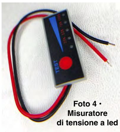
**Foto 4 • Misuratore di tensione a led**
