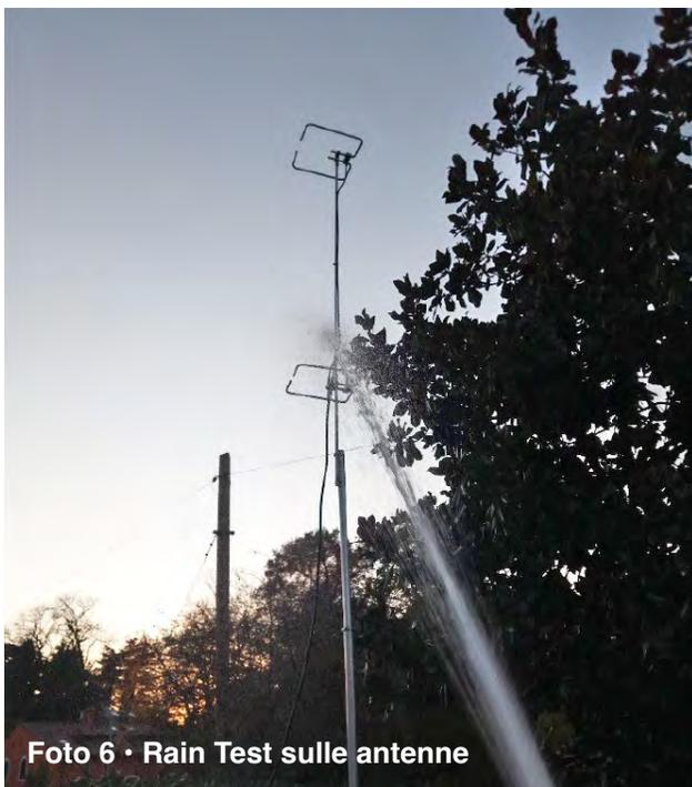
Foto 6 • Rain Test sulle antenne
