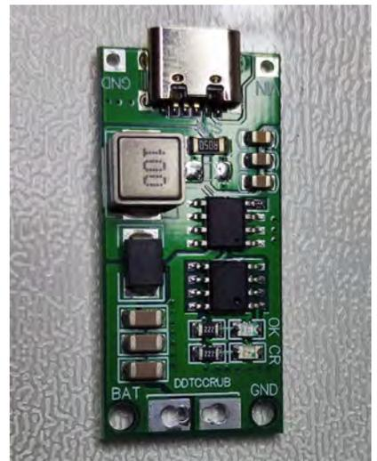
**Foto 5 • Caricatore USB-C da 8.4 V specifico per due pile in serie**
