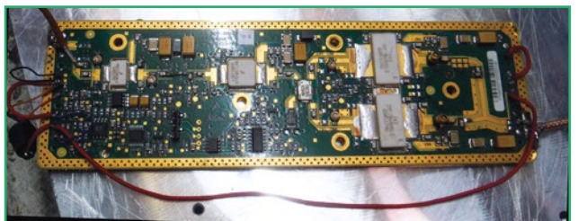
Figura 5 • L'amplificatore surplus con MRF21010, MRF21045 e una coppia di SRF7068
