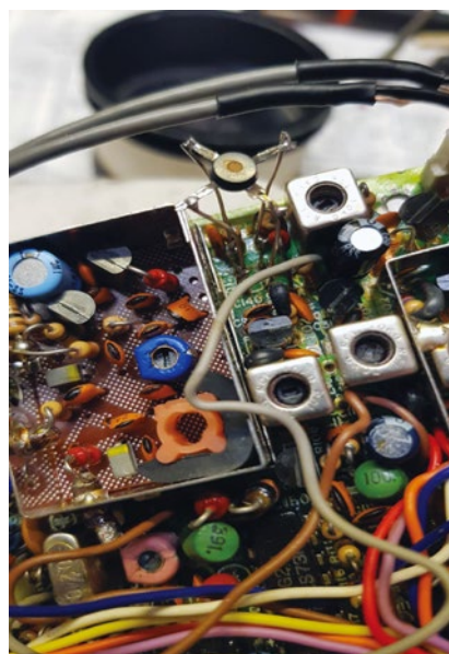
Punto dello stampato dove è alloggiato il Dual Fet e montato provvisorio sul circuito
