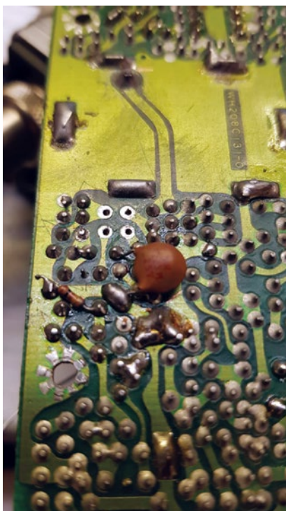
Punto dello stampato dove è alloggiato il Dual Fet e montato provvisorio sul circuito
