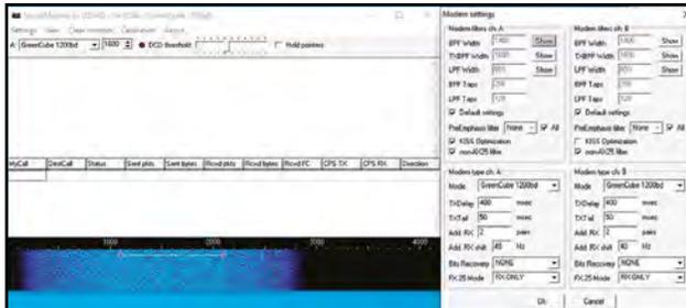
Lasciate tutto come di *default*, eventualmente aggiungete la spunta su *NON\_AX25 FILTER*, anche se non strettamente necessario, l'importante che controlliate che i dati inseriti siano gli stessi sopra riportati, dopo di che date Ok e con il *soundmodem* la configurazione è completa.
