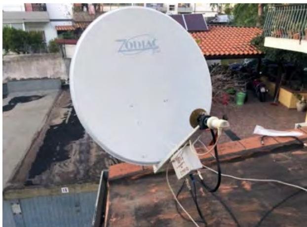
Foto 2 • La parabola con setup per QO-100
