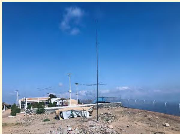
**Visione verso nord-ovest della disposizione antenne di J28MD.** Il reticolato dà su una profonda scarpata verso nord. In primo piano la verticale "full size" per gli 80 m, sullo sfondo due "Spiderbeam"
