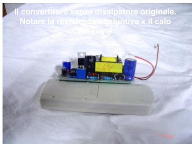
Il convertitore senza dissipatore originale. Notare la resistenza aggiuntiva x il calo di tensione.
