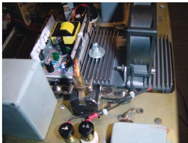
Convertitore visto da dietro. Notare i contatti + e - del Binding Post x alimentare la ventolina. Al centro il bullone che unisce in dissipatore alla culla del DM originale
